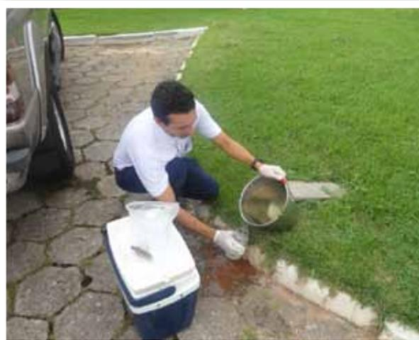
**Gefis 44 (coleta de amostra de esgoto para análise na ETE insular, chegada do esgoto bruto e saída do esgoto tratado).**
