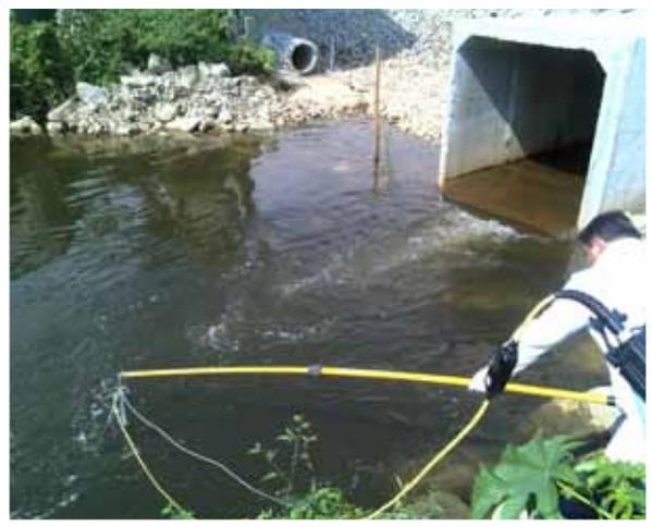
Balneário Camboriú – Gefis 45 (coleta de amostra de esgoto para análise na chegada e na zona de mistura).
