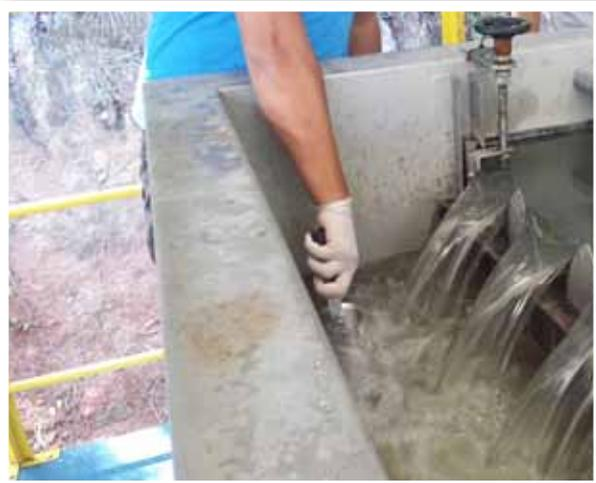
**Bombinhas – Gefis 110 (qualidade da água e esgoto – coleta de amostra de água para análise em diversos pontos do sistema e coleta de esgoto na entrada e saída da ETE).**
