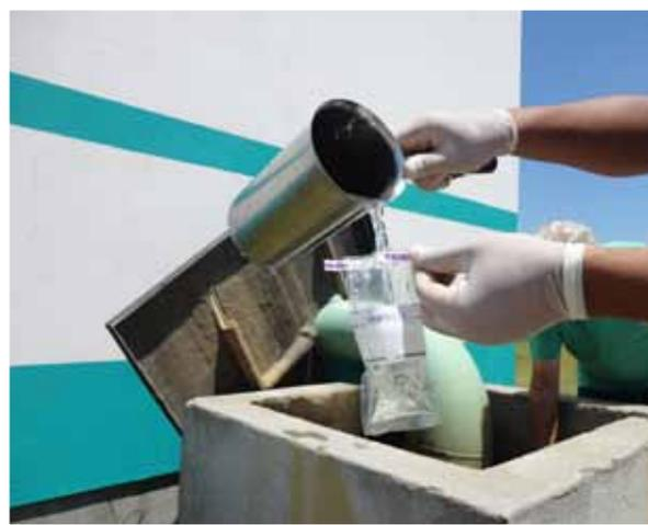
**Laguna – Gefis 109 (qualidade da água e esgoto – coleta de amostra de água para análise em diversos pontos do sistema e coleta de esgoto na entrada e saída da ETE).**
