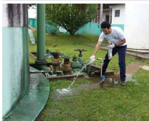
**Santa Cecília – Gefis 91 (coleta de amostra de água para análise na ETA e no reservatório R1).**
