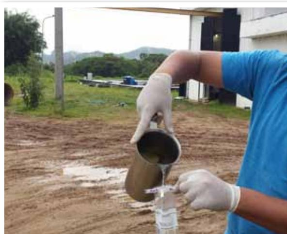
Balneário Camboriú – Gefis 106 (qualidade da água e esgoto – coleta de amostra de água para análise em diversos pontos do sistema e coleta de esgoto na entrada e saída da ETE).
